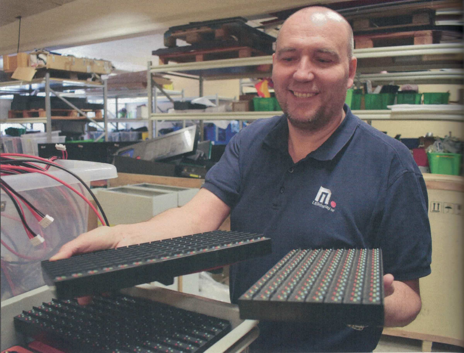
Jan Niskala visar upp gamla led-moduler som består av dip-dioder, det vill säga tre lampor i varje liten enhet som representerar grön, gul och röd.
